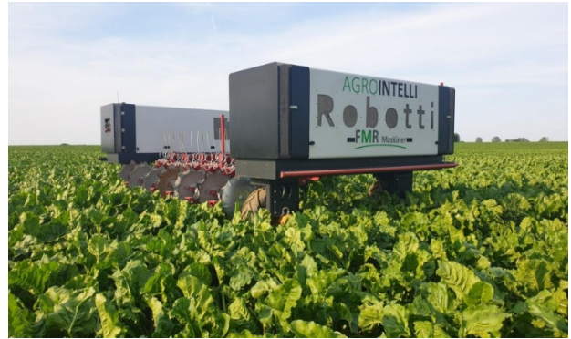
Robotai mechaniškai naikina piktžolės javų (kairėje) ir cukrinių runkelių (dešinėje) laukuose (AGROINTELLI nuotrauka)
