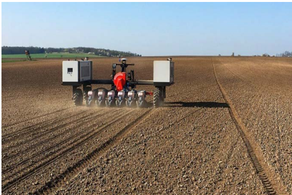
Sėja (kairėje) ir sodinimas (dešinėje) padedant robotui (AGROINTELLI nuotrauka)
