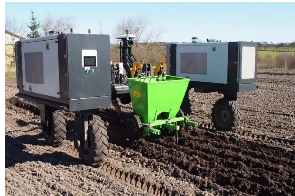
Sėja (kairėje) ir sodinimas (dešinėje) padedant robotui (AGROINTELLI nuotrauka)
