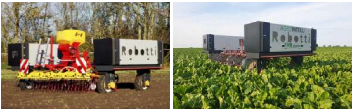
Robotti a realizar a monda mecânica em cereais (esquerda) e em beterraba sacarina (direita). Foto: AGROINTELLI
