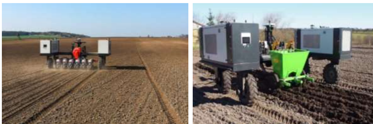
Robotti a semear (esquerda) e a plantar (direita). Foto: AGROINTELLI
