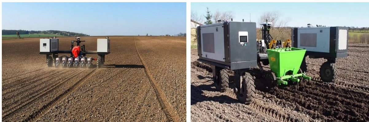
Výsev (vlevo) a výsadba (vpravo) pomocí Robotů. Foto: AGROINTELLI
