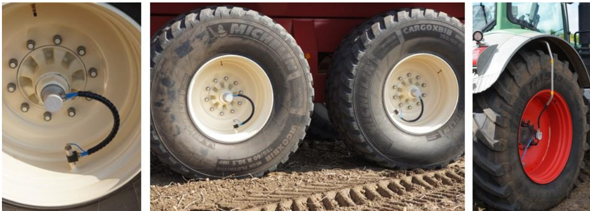
Systém variabilného nahustenia pneumatík , Zdroj: Cumela
